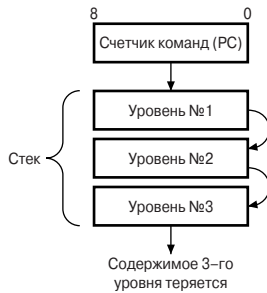
Рис. 2.30. Работа стека при выполнении команды CALL
